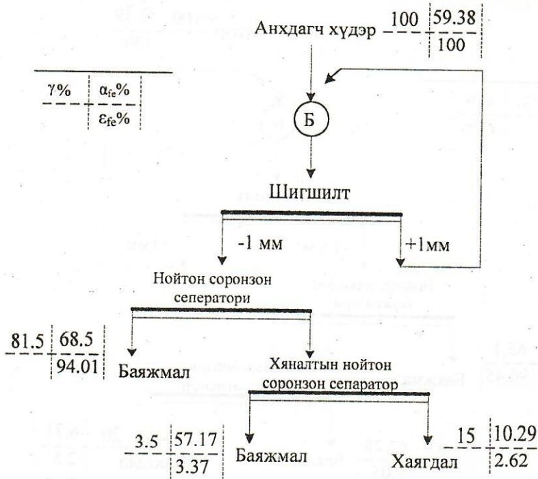
1-р зураг. Хар төмөртэйн ордын хүдрийн баяжуулалтын туршилтын схем
