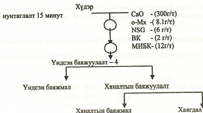
4-р зураг. Зэс-молибдены хүдрийг баяжуулах NSG-(6г/т флотореагент хэргэлсэн технологийн схем Хүдэр баяжуулсан технологийн нөхцөл: pH=10, BK- 2 г/т, Аеро-Мх-8, 4 г/т, NSG- 6 г/т, МИБК -12 г/т
