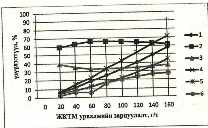
1-р зураг. Шүтлэг орчин дахь флюорит ба кальцитын дагнасан флотацийн үзүүлэлтүүд ба ЖКТМ урвалжийн зарцуулалтын хоорондын хамаарал 1 - баяжсмалын гарц; 2 - \text{CaF}_2 -ын агуулга; 3 - \text{CaCO}_3 -ын агуулга; 4 - \text{CaF}_2 -ын авалт; 5 - \text{CaCO}_3 -ын авалт; 6-баяжуулалтын үр ашгийн шалгуур
