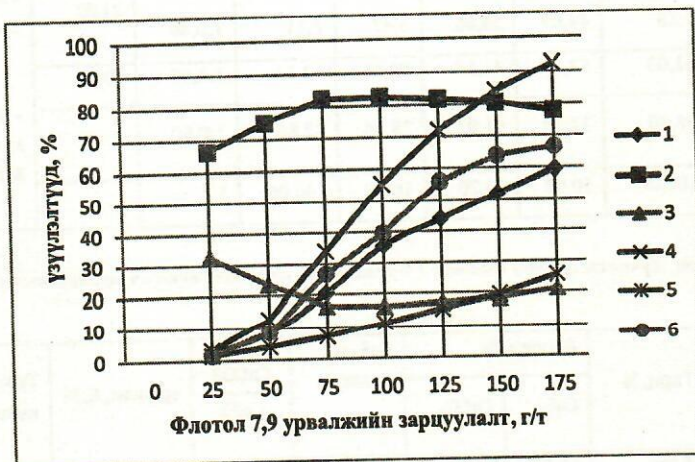
2-р зураг. Шүтлэг орчин дахь флюорит ба кальцитын дагнасан флотацийн үзүүлэлтүүд ба Флотол 7,9 урвалжийн зарцуулалтын хоорондын хамаарал 1- баяжсмалын гарц; 2 - \text{CaF}_2 -ын агуулга; 3 - \text{CaCO}_3 -ын агуулга; 4 - \text{CaF}_2 -ын авалт; 5 - \text{CaCO}_3 -ын авалт; 6-баяжуулалтын үр ашгийн шалгуур
