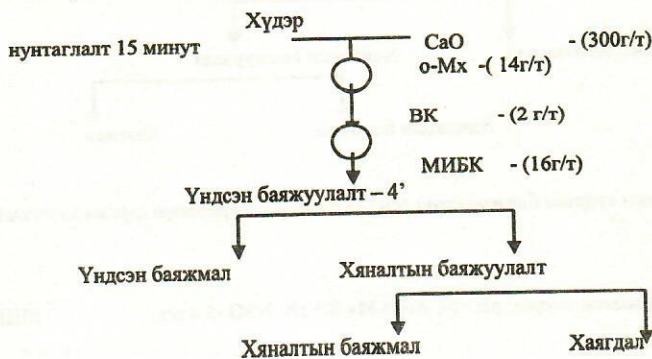
1-р зураг. Зэс-молибдены хүдрийг импортын флотореагентууд хэрэглэж баяжуулсан технологийн ерөнхий схем
