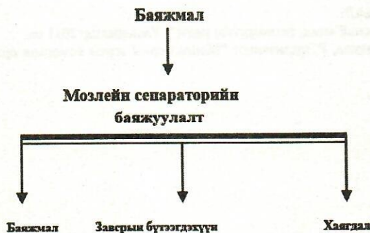
Зураг 1. Төмрийн баяжмалыг Мозлейн сепаратораар баяжуулсан технологийн бүдүүвч
