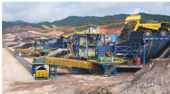
1-р зураг. Хагас хөдөлгөөнт бутлуур-конвейерийн иж бүрдэл бүхий технологи
