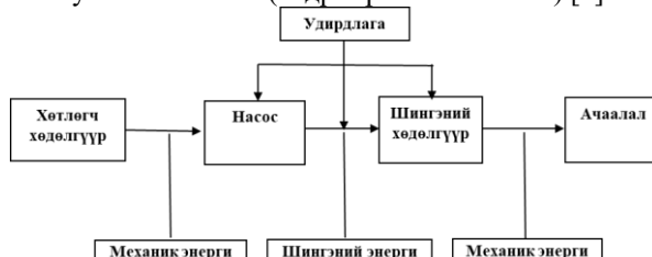
Зураг 1. Гидроприводын бүтцийн схем
