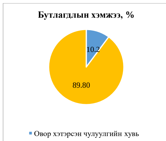
6-р зураг. Гранулометрийн аргаар тодорхойлсон 1274-р тэслэгдсэн блокийн овор хэтэрсэн чулуулгийн хэмжээ, хувь
